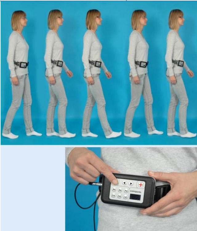
Abb. 1 ◀ Vertiguard®-System bei der Rehabilitation der posturalen Kontrolle in alltagsrelevanten Gleichgewichtskonditionen (z. B. Laufen). Unten Gerät am Hüftgurt bei der Anwahl der individuellen Trainingsoptionen
